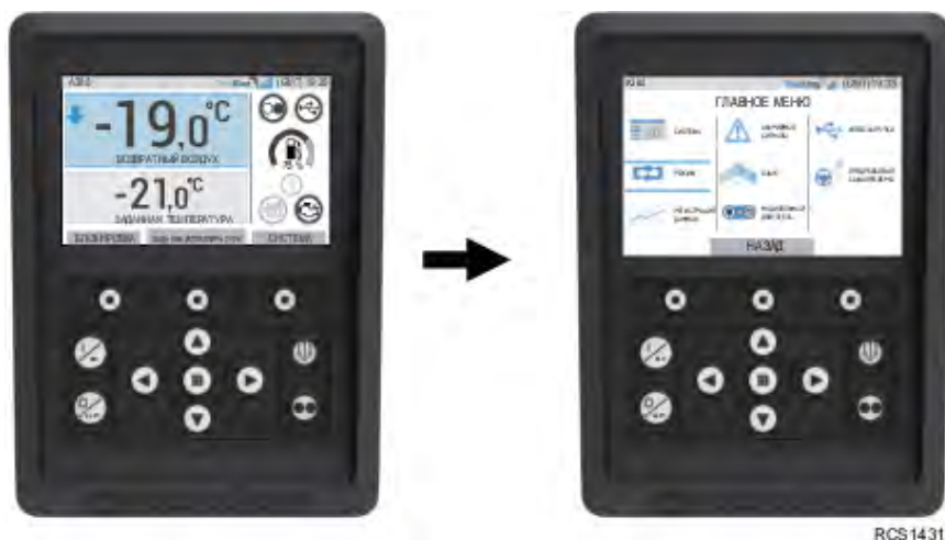
Рис. 13. Показаны стандартный экран и экран главного меню
