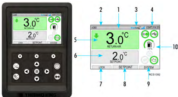
Рис. 11. Показаны стандартный экран и описание пиктограмм
