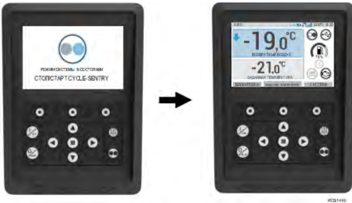
Рис. 22. Показан режим Cycle-Sentry
