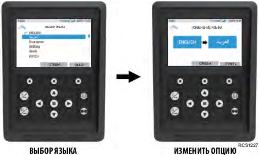
Рис. 17. Показаны экраны выбора языка
