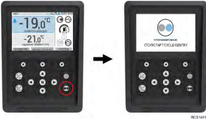
Рис. 22. Показан режим Cycle-Sentry
