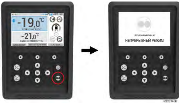
Рис. 19. Показан непрерывный режим
